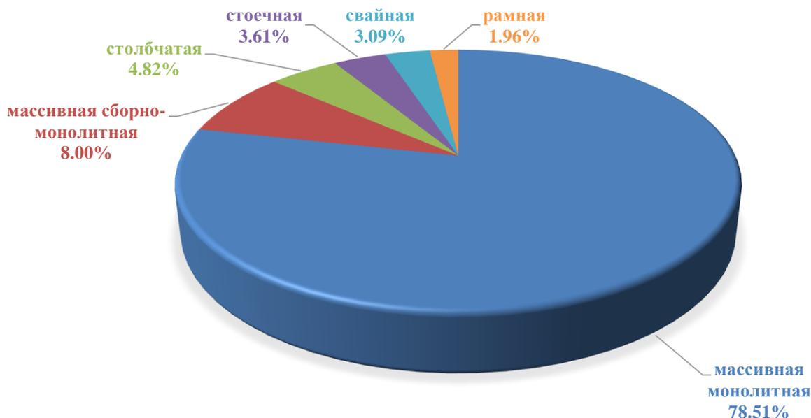
Рисунок 2.3 – Диаграмма распределения природно-техногенных систем по конструкции тела опор
