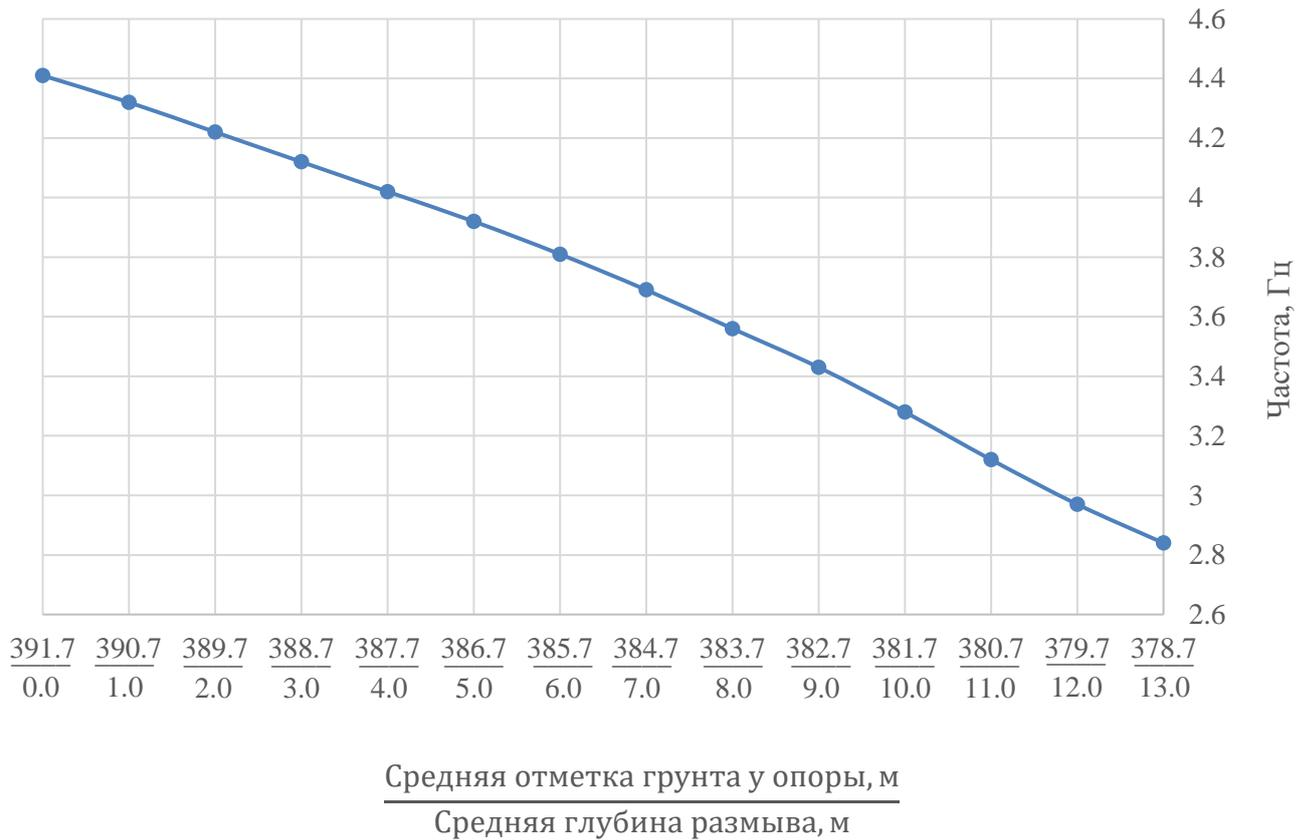
Рисунок 3.12 – График изменения частоты собственных колебаний опоры ОЗ моста М4 от глубины размыва (первая форма колебаний)
