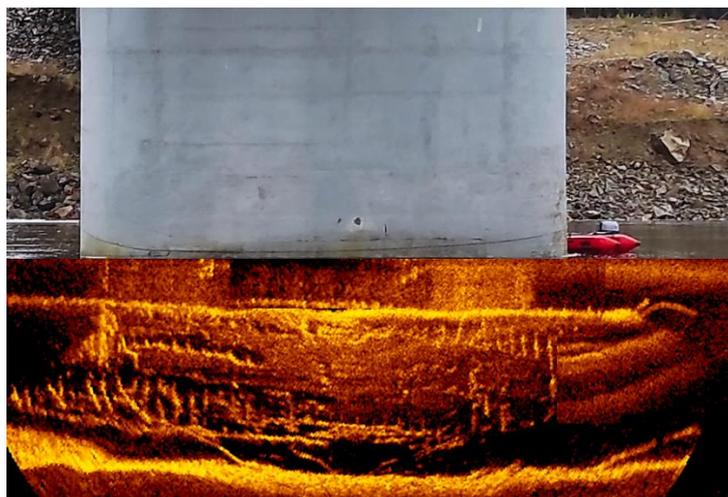
Рисунок 2.10 – Акустическое изображение подводной конструкции опоры [109]
