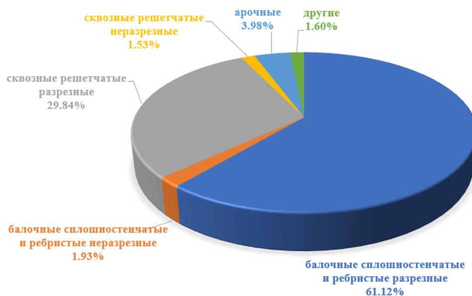
Рисунок 2.1 – Диаграмма распределения природно-техногенных систем по типу опирающихся на опору пролетных строений
