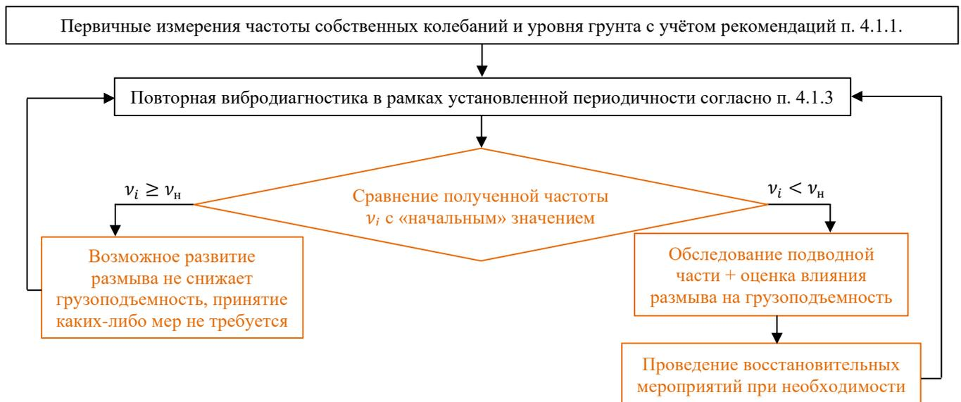
Рисунок 4.4 – Алгоритм контроля размыва грунта при отсутствии данных о конструкции невидимой части опоры и геологическом строении основания
