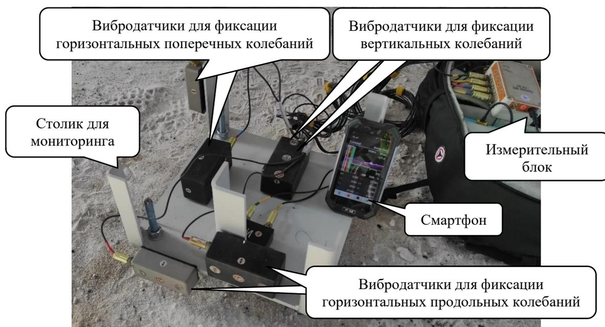
Рисунок 2.12– Пример установки измерительного оборудования
