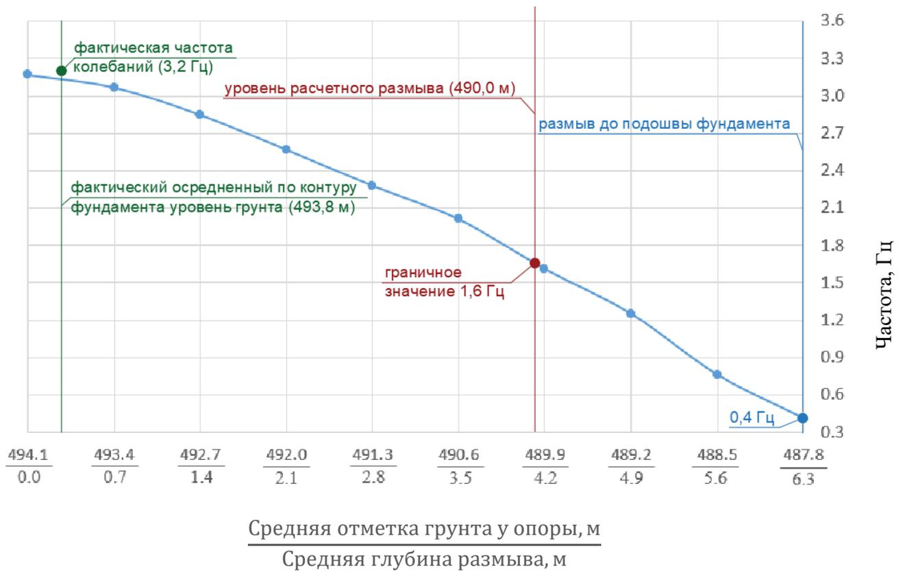
Рисунок 4.13 – График изменения частоты собственных колебаний опоры в зависимости от глубины размыва
