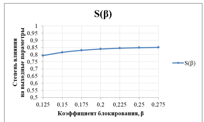
Рисунок 3.7 – Степень влияния коэффициента блокирования на максимальный перепад
