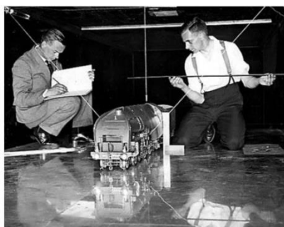
Рисунок 1.31 – Тестирование в аэродинамической трубе сопротивления модели локомотива (Британская национальная физическая лаборатория, 1932 г.) [150]
