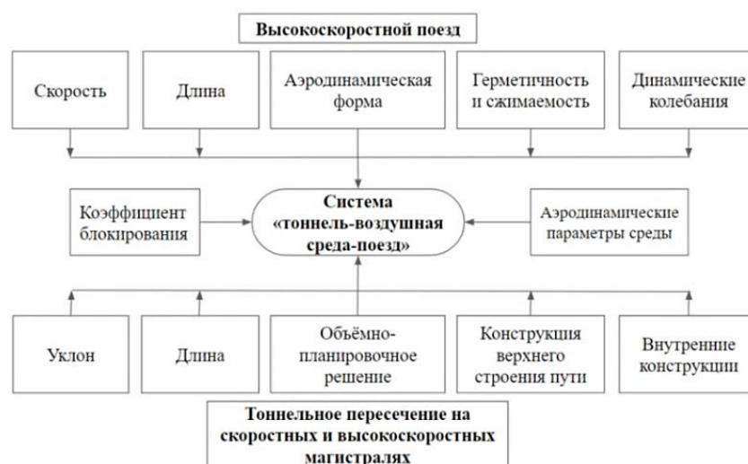
Рисунок 1.20 – Многофакторная система «тоннель – воздушная среда – поезд»
