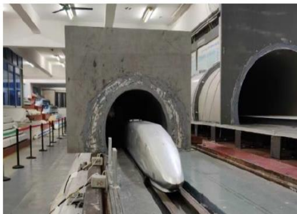
Рисунок 1.32 – Стенд для исследования движения поезда в тоннеле [148]
