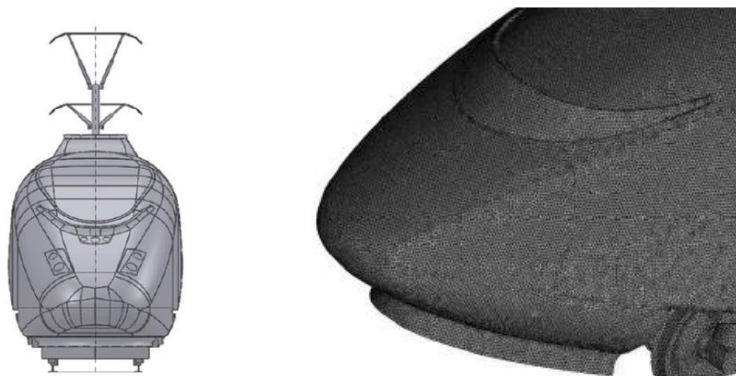
Рисунок 2.1 – Пример модели подвижного состава с элементами расчетных сеток
