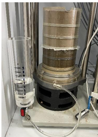
Рисунок 3.5 – Подготовленные для проведения эксперимента грунтовые модели в установке ГТ 1.1.12
