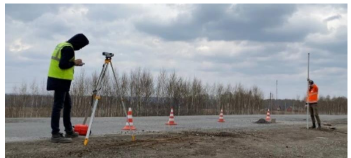
Рисунок 2.9 – Рабочие моменты при контроле за вертикальными перемещениями асфальтобетонного покрытия
