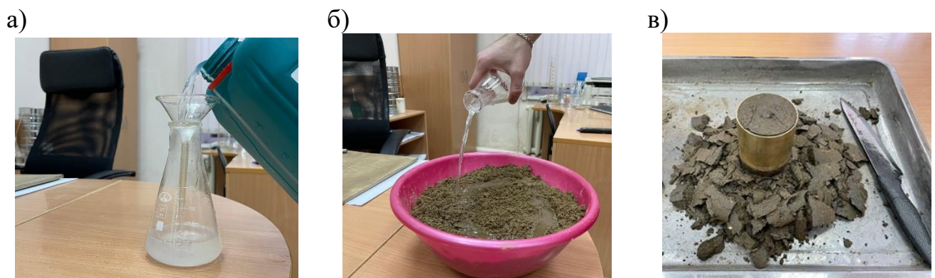
Рисунок 3.9 – Приготовление образца из силикатизированного грунта:
