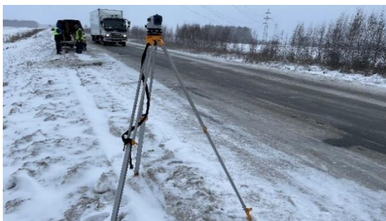
Рисунок 2.9 – Рабочие моменты при контроле за вертикальными перемещениями асфальтобетонного покрытия
