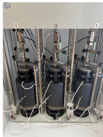
Рисунок 3.5 – Подготовленные для проведения эксперимента грунтовые модели в установке ГТ 1.1.12
