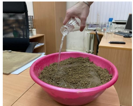
Рисунок 3.14 – Подготовка силикатизированного грунта
